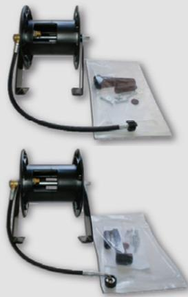
Schlauchtrommeln vereinfachen den Transport sowie die Sicherung und Lagerung langer Hochdruckschläuche. Hochwertige Drehgelenke bei allen Ausführungen. Sonderausführung zum Einsatz in explosionsgefährdeten Bereichen. Typ 300 bar für 30 m NW 8 bzw. 42 m NW 6, Typ 500 bar für max. 60 m NW 8, Federzug-Schlauchaufroller für 20 m NW 8 – in Stahl (lackiert) oder V2A für Wandmontage, auch mit Schwenkvorrichtung.
