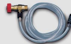
Durch Niederdruck-Injektoren wird Reinigungsmittel pumpenschonend hinter der HD-Pumpe eingespeist – serienmäßig bei allen Oertzen-Geräten bis 5,5 kW. Economy-Injektor mit fester Zumischrate (10 %), Vario-Injektor regelbar von 0 bis 10 %, Niedermengen-Injektor für Reinigungsmittelersparnis bei langen Schläuchen.
