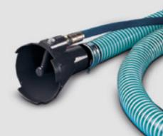
Angeschlossen an den Hochdruckreiniger, fördert der Schlamm-sauger nach dem Venturi-Prinzip (Unterdruck) Schlamm und Flüssigkeiten bis zu einer Höhe von 5 m (abhängig von der Leistung des angeschlossenen Hochdruckreinigers). Restlose Absaugung für Tanks, Fässer, Gruben, Schächte und mehr. Saugschlauch-Durchmesser 1 1/2", Schlauchlänge 3,5 m.
