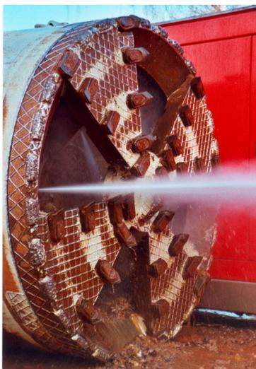
Je nach Größe des Vortriebsaggregates sind zwei bis sechs Hochdruckwasserdüsen installiert, um ein vorzeitiges Festsetzen des Materials zu verhindern.
